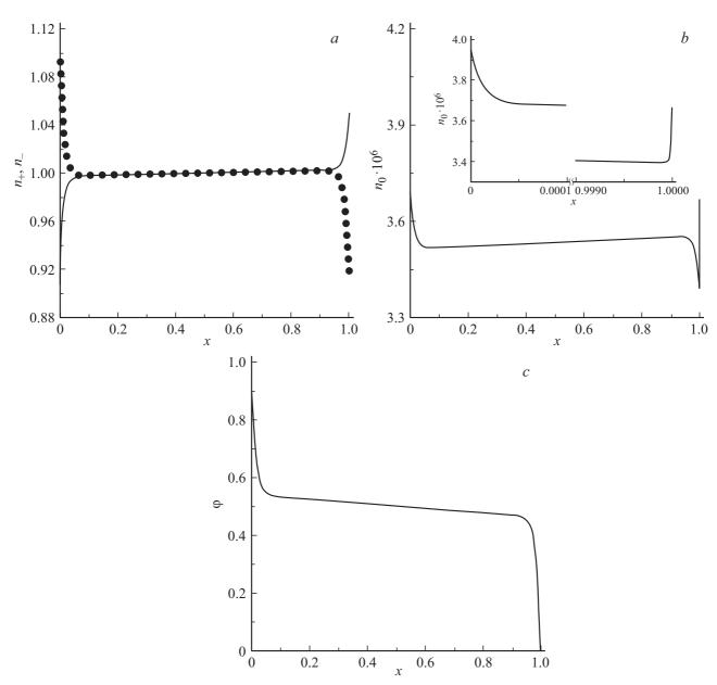
**Рис. 2.** Профили концентрации положительных (сплошная линия) и отрицательных (точки) ионов (a), ионных пар (b) и электрического потенциала (c) при h=0.001 m,  $\varphi_0=0.01$  V,  $\overline{n}_0=10^{17}$  m $^{-3}$ .
