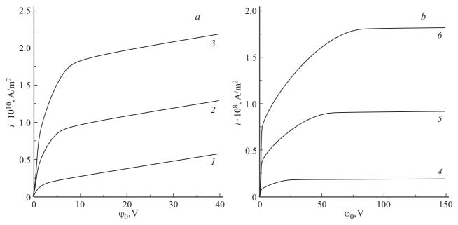
**Рис. 7.** Размерные ВАХ при  $h=0.001\,\mathrm{m}$ .  $\overline{n}_0$ :  $I=10^{16}$ ,  $2=5\cdot10^{16}$ ,  $3=10^{17}$ ,  $4=10^{18}$ ,  $5=5\cdot10^{18}$ ,  $6=10^{19}\,\mathrm{m}^{-3}$ .
