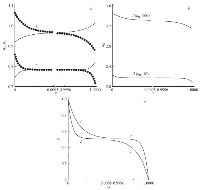
**Рис. 3.** Профили концентрации положительных (сплошная линия) и отрицательных (точки) ионов (a), ионных пар (у кривых I и 2 значения концентрации домножены на 100 и 10 соответственно) (b) и электрического потенциала (c) при h=0.001 m,  $\varphi_0=0.01$  V:  $I-\overline{n}_0=10^{21}$  m<sup>-3</sup>,  $2-\overline{n}_0=10^{22}$  m<sup>-3</sup>.
