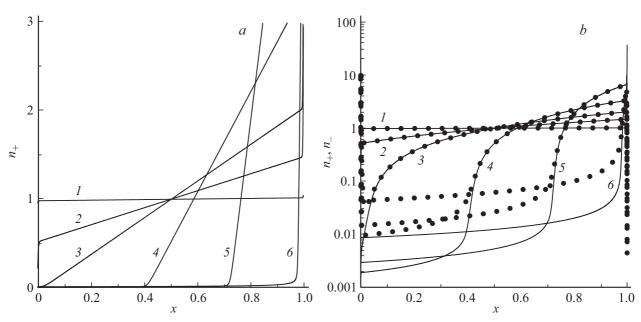
**Рис. 8.** Распределения концентрации положительных (сплошные линии) и отрицательных (точки) ионов при  $h=0.01\,\mathrm{m}$ ,  $\overline{n}_0=10^{17}\,\mathrm{m}^{-3}$ .  $\varphi_0$ : I=0.01, I
