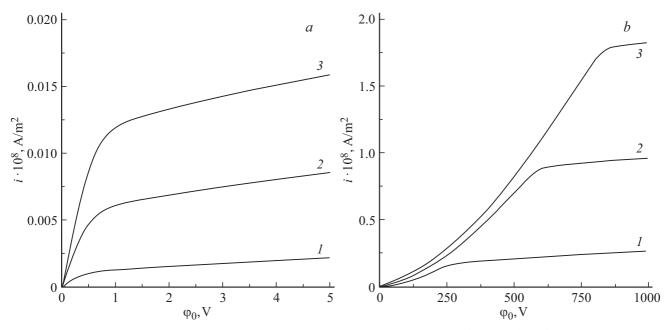
**Рис. 9.** Размерные ВАХ при  $h=0.01\,\mathrm{m}$ .  $\overline{n}_0$ :  $I=10^{16},\,2-5\cdot10^{16},\,3-10^{17}\,\mathrm{m}^{-3}$ .
