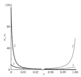
**Рис. 4.** Профили концентрации положительных (сплошная линия) и отрицательных (точки) ионов при  $h=0.001\,\mathrm{m}$ ,  $\overline{n}_0=10^{17}\,\mathrm{m}^{-3}$ :  $I-\phi_0=0.3\,\mathrm{V}$ ,  $2-\phi_0=0.8\,\mathrm{V}$ .
