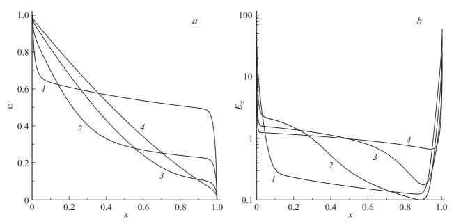
**Рис. 6.** Профили электрического потенциала (*a*) и *x*-компоненты напряженности электрического поля (*b*) при  $h=0.001\,\mathrm{m}$ ,  $\overline{n}_0=10^{17}\,\mathrm{m}^{-3}$ .  $\varphi_0$ : I=0.8, I=0.8,
