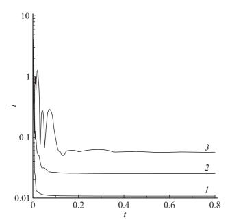
**Рис. 1.** Зависимости безразмерной удельной силы тока от времени при  $h=0.001\,\mathrm{m}$  и  $\overline{n}_0=10^{20}\,\mathrm{m}^{-3}.$   $\varphi_0$ :  $I=0.5,\ 2=0.75,\ 3=1\,\mathrm{V}.$
