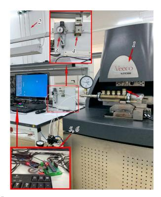
**Рис. 3.** Стенд для измерения механических и структурных свойств тонких пленок: I — оптический профилометр Veeco Wyko NT9300, 2 — магистраль, 3 — фильтр-регулятор, 4 — пропорциональный регулятор давления, 5 — плата Arduino Mega 2560, 6 — печатная плата с различными компонентами, 7 — образец.
