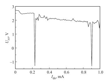
**Рис. 2.** Изменение величины напряжения  $U_{xx}$  в зависимости от величины стабилизированного тока исток—сток,  $I_{ds}$ . T=300 K.
