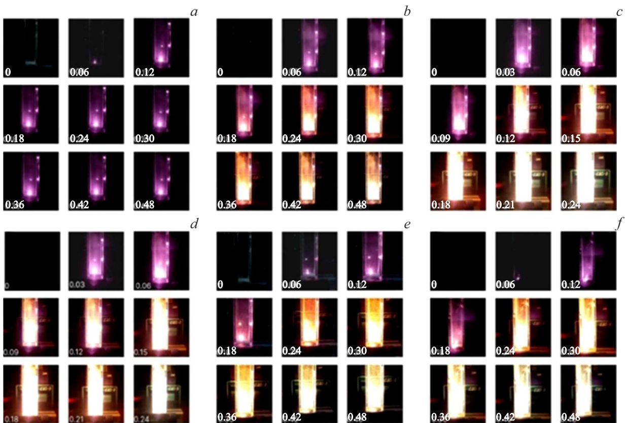
Рис. 4. Изменение со временем (указано в секундах) цвета излучения образца \text{ZrO}_2 - 30 \text{ mol.}\% \text{ Yb}_2\text{O}_3 с температурой отжига 500^\circ\text{C} при возбуждении непрерывным лазерным излучением с \lambda = 980 \text{ nm} , J = 0.5 \text{ kW/cm}^2 (a), 1.3 \text{ kW/cm}^2 (b), 2.1 \text{ kW/cm}^2 (c) и образцов, отожжённых при температурах 500^\circ\text{C} (d), 800^\circ\text{C} (e) и 1150^\circ\text{C} (f) при возбуждении непрерывным лазерным излучением с \lambda = 980 \text{ nm} , J = 2.1 \text{ kW/cm}^2 .
