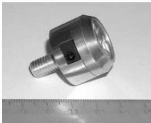
Рис. 3. Конструкция мощного светодиода (1–10 Вт) в виде „алюминиевого болта“.
