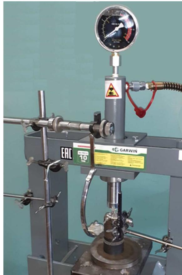
**Рис. 1.** Общий вид установки для генерации АЭ при ударном повреждении одноосно сжатого образца ЦК.
