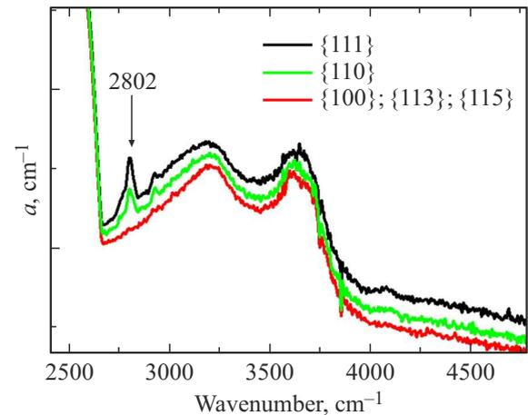
**Рис. 2.** Спектры IR-поглощения секторов роста {111}, {110}, {100}, {113}, {115} НРНТ-алмаза в спектральной области с полосой поглощения бора  $2802\text{ cm}^{-1}$ .
