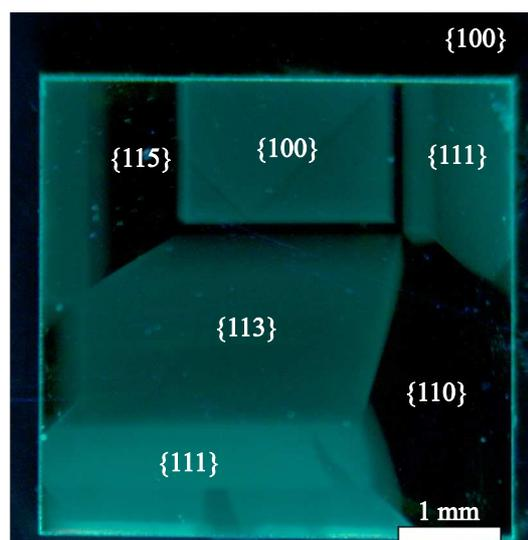
**Рис. 1.** Изображение секторального внутреннего строения изучаемой алмазной пластины, полученное методом фотолюминесцентной микроскопии (при возбуждении  $\lambda = 220\text{ nm}$ ).
