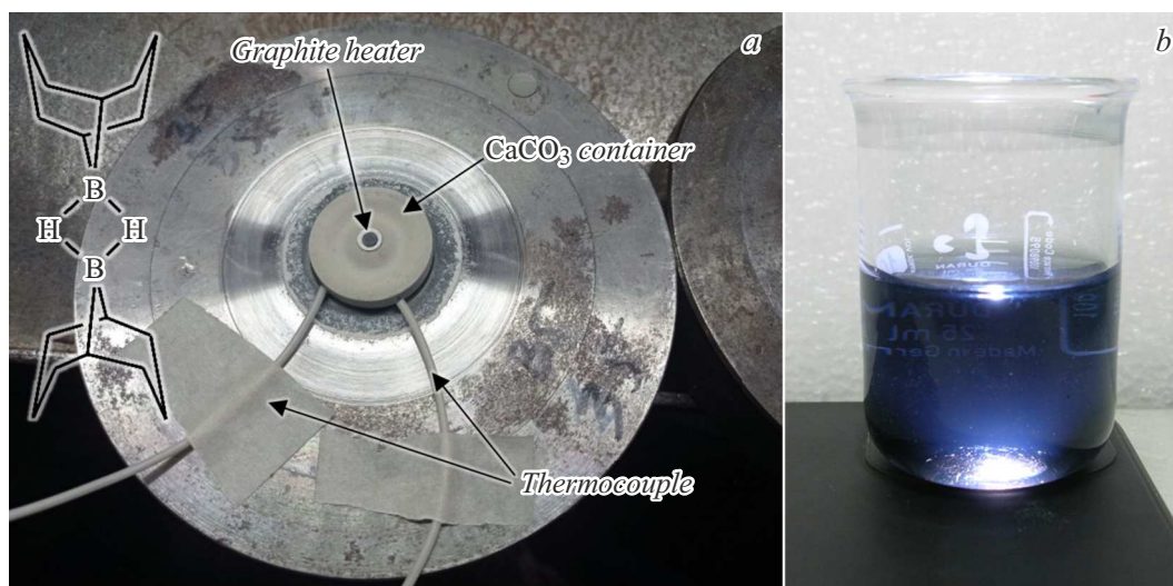
Рис. 1. a — камера высокого давления со снаряженным контейнером и термопарой, на вставке — структурная формула исходного вещества 9-борабицикло[3.3.1]нонан димера; b — коллоидный раствор легированных бором наноалмазов.
