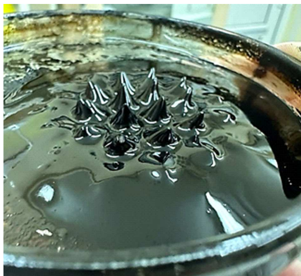
Рис. 1. Изображение магнитного композита на основе МГ под воздействием магнитного поля.
