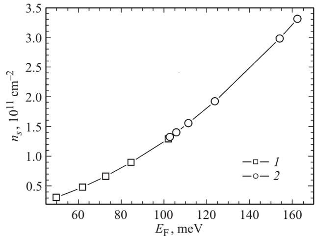
**Рис. 8.** Поверхностная концентрация фермионов Дирака  $n_s$  в зависимости от энергии Ферми  $E_F$  в твердом растворе  $p\text{-Bi}_{0.45}\text{Sb}_{1.55}\text{Te}_{2.985}$ : нанокompозите с микровключениями 3%  $\text{SiO}_2$  (1) и наноструктурированном поликристалле (2).
