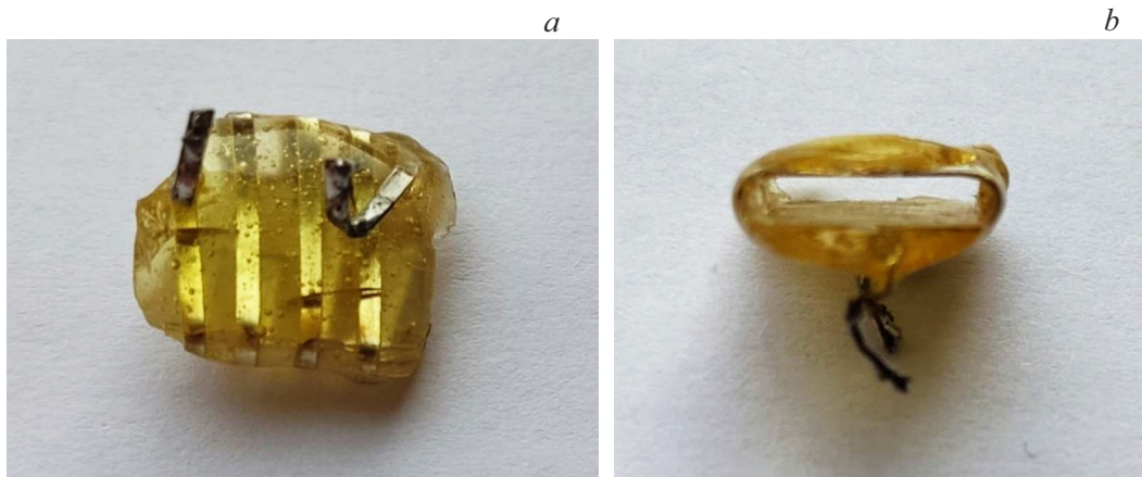
Рис. 1. Измерительная катушка для записи сигнала ЯМР от ядер ^{59}\text{Co} для нанопроволок: вид сверху (а) и вид сбоку (b).
