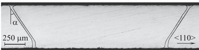
**Рис. 2.** Фотография поперечного сечения замкнутой ячейки, сформированной кольцевой зоной. Сечение в направлении  $\langle 110 \rangle$  по диаметру зоны. Финишная поверхность пластины внизу. Температура процесса ТМ — 1300 К.
