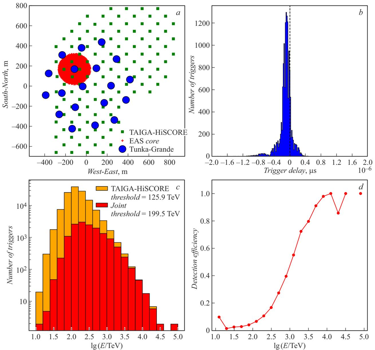
**Рис. 1.** Пример совместных событий одной из станций установки Tunka-Grande и оптических детекторов установки TAIGA-HiSCORE: *a* — схема расположения станций, оптических детекторов и осей ШАЛ при радиусе отбора событий  $R_s = 150$  м; *b* — гистограмма разности времен регистрации ШАЛ; *c* — количество ШАЛ по данным установки TAIGA-HiSCORE и совместных событий в зависимости от энергии ПКИ; *d* — эффективность совместной регистрации.
