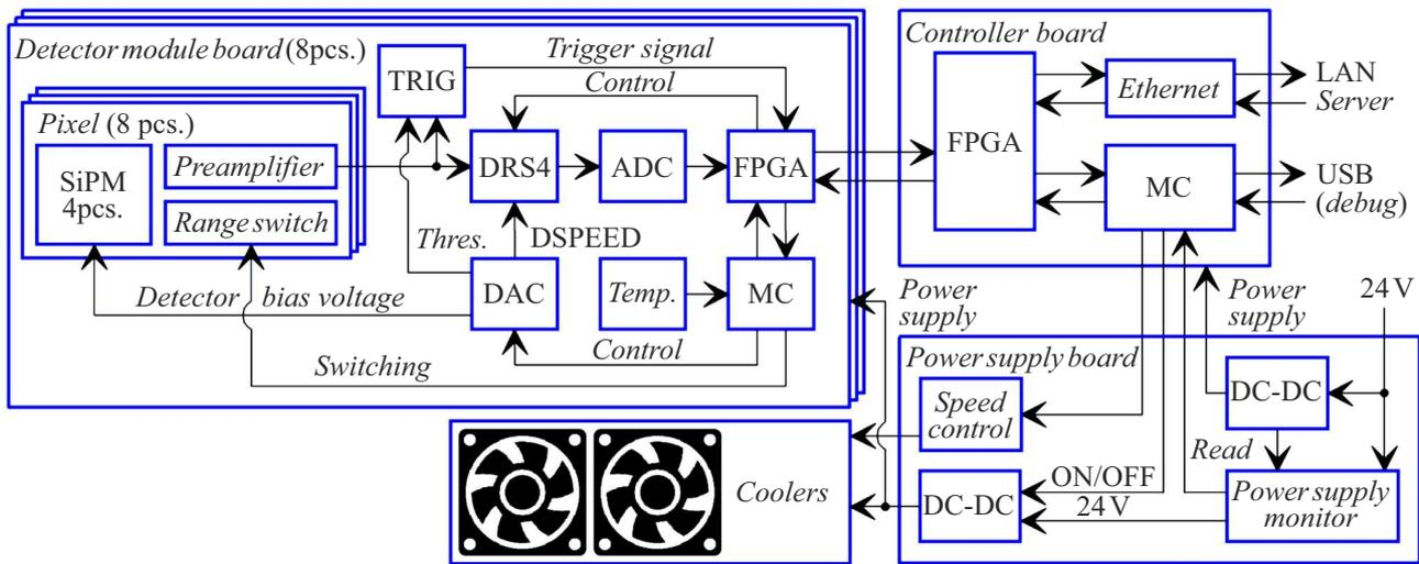
Рис. 2. Общая структурная схема прототипа камеры телескопа ALEGRO.
