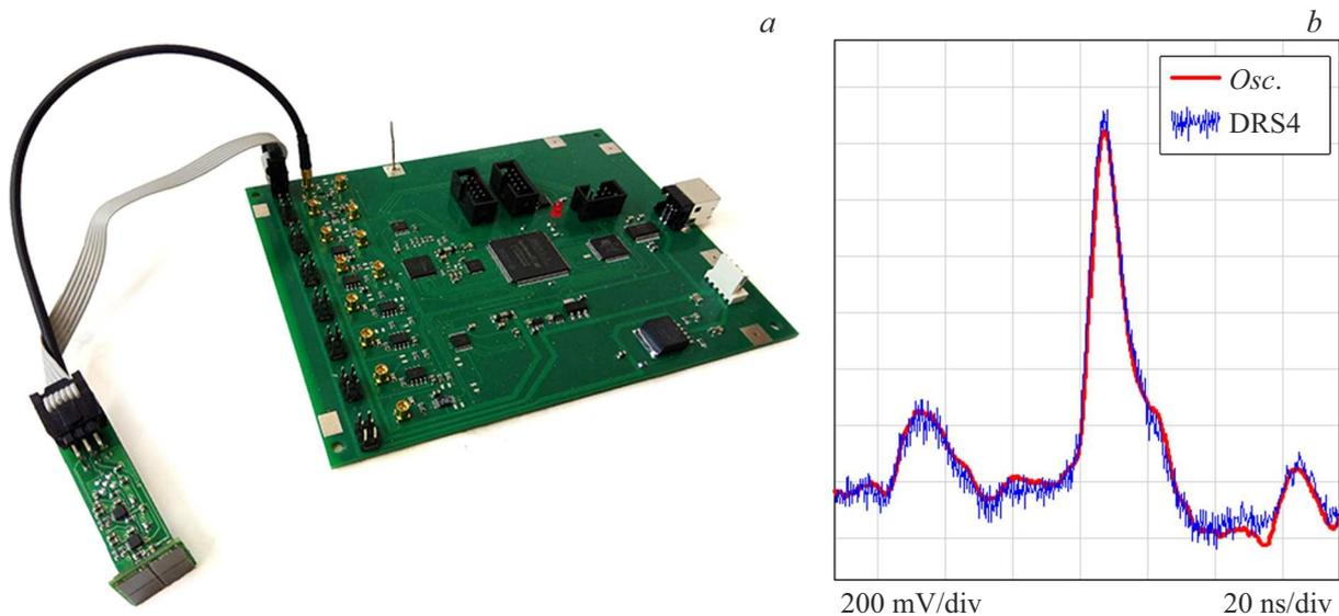
**Рис. 3.** Фотография созданного макета канала регистрации (а) и сравнительное наложение двух осциллограмм одного импульса (b).
