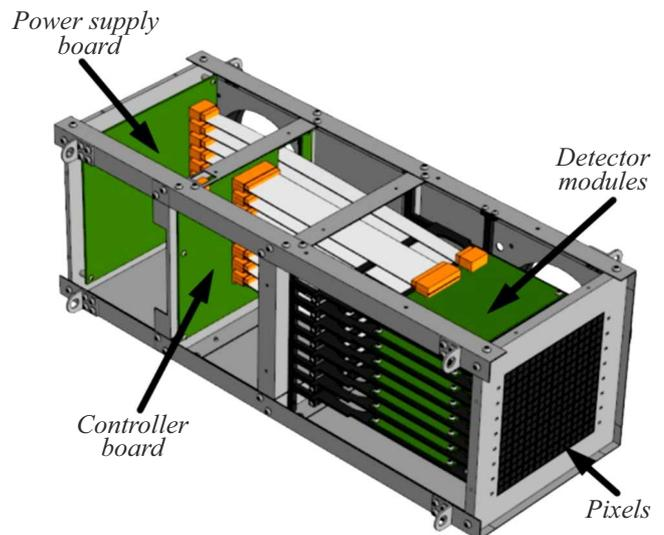
Рис. 1. 3D-модель конструкции прототипа камеры ALEGRO без корпуса.
