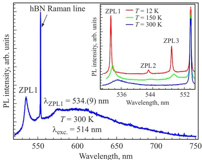
**Рис. 2.** Спектр  $\mu$ -ФЛ образца hBN S1, зарегистрированный при температуре  $T = 300$  K, при возбуждении лазером  $\lambda = 514$  nm. На вставке приведена зависимость интенсивностей и положений линий ZPL1–ZPL3 от температуры.
