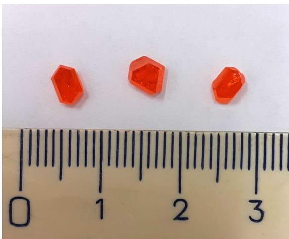
Рис. 1. Монокристаллы CsPbBr<sub>3</sub>.
