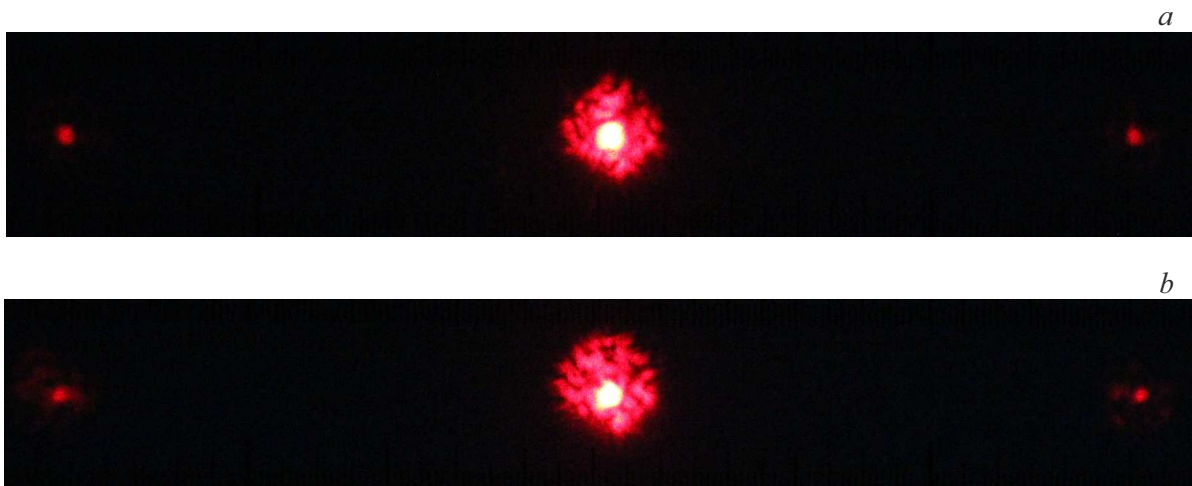
Рис. 3. Картины в дальней зоне для вырожденной анизотропной дифракции Брэгга двукратного типа на доменных стенках РДС ( \Lambda = 7.99 \mu\text{m} ) в кристалле 1\% \text{MgO}:\text{LiTaO}_3 : (a) — при T_{dgb} = 41.5^\circ\text{C} и необыкновенном зондирующем пучке, см. векторную диаграмму на рис. 2, a; (b) — при T_{dgu} = 91.5^\circ\text{C} и обыкновенном зондирующем пучке, см. векторную диаграмму на рис. 2, b.
