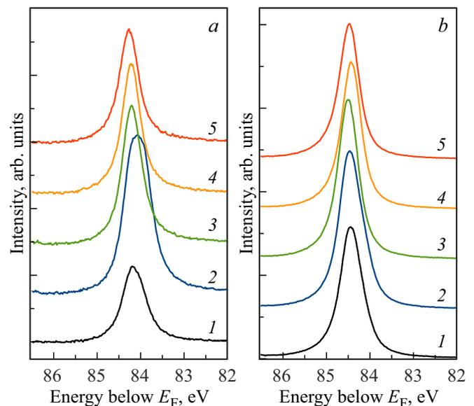
**Рис. 1.** Спектры нормальной фотоэмиссии остовного уровня Au 4*f*<sub>7/2</sub> исследуемого образца при энергии возбуждения  $h\nu$ , равной а) 140 eV и б) 600 eV: кривые 1 — подготовленный образец, 2 — после 10 min прогрева при  $T = 850$  K, 3 — после напыления Na в течение 2.5 min, 4 — после напыления Na в течение 5.0 min и 5 — после напыления Na в течение 7.5 min.
