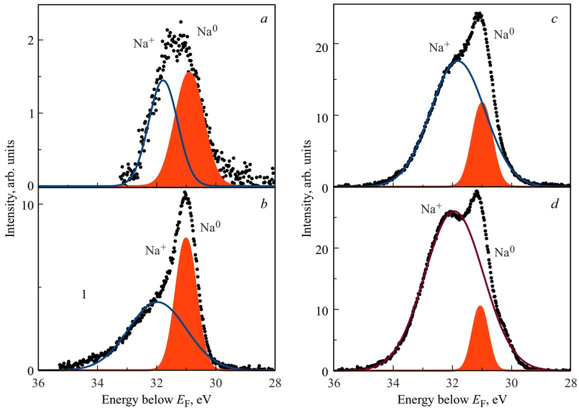
**Рис. 2.** Анализ спектров фотоэмиссии остовных уровней  $\text{Na } 2p$  *a*) после прогрева при  $T = 850 \text{ K}$  в течение 10 min, *b*) после напыления  $\text{Na}$  в течение 2.5 min, *c*) после напыления  $\text{Na}$  в течение 5.0 min и *d*) после напыления  $\text{Na}$  в течение 7.5 min, при энергии возбуждения  $h\nu = 80 \text{ eV}$ . Точками показан экспериментальный спектр, жирными сплошными линиями — вклад состояний  $\text{Na}^0$  и  $\text{Na}^+$ .
