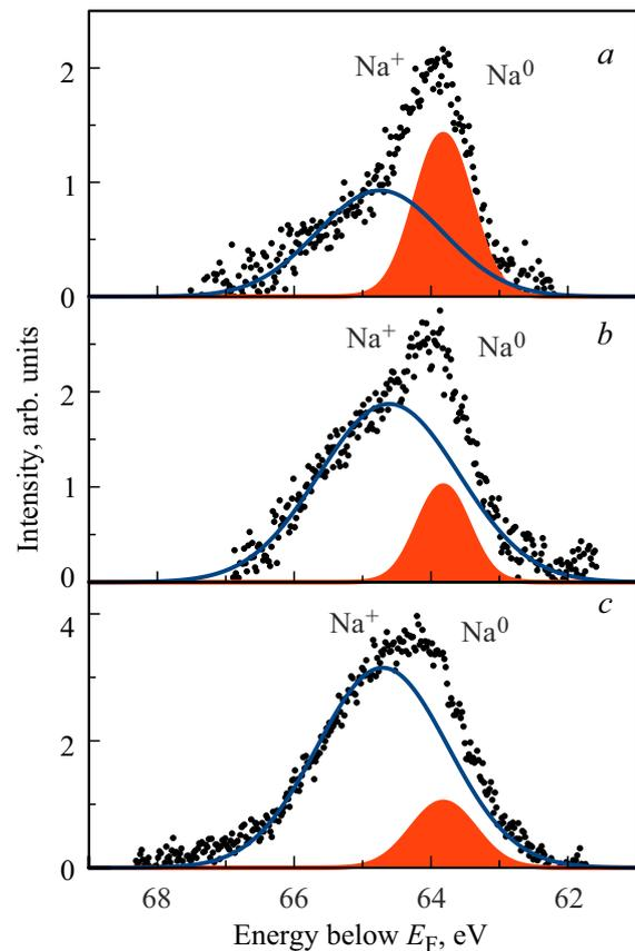
**Рис. 4.** Анализ спектров фотоэмиссии остовных уровней Na  $2s$  а) после напыления Na в течение 2.5 min, б) после напыления Na в течение 5.0 min и в) после напыления Na в течение 7.5 min, при энергии возбуждения  $h\nu = 300$  eV. Точками показан экспериментальный спектр, жирными сплошными линиями — вклад состояний  $\text{Na}^0$  и  $\text{Na}^+$ .
