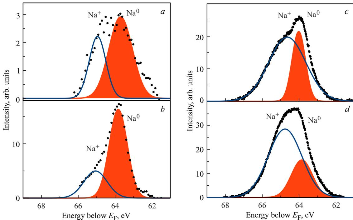
**Рис. 3.** Анализ спектров фотоэмиссии остовных уровней  $\text{Na } 2s$  *a*) после прогрева при  $T = 850 \text{ K}$  в течение 10 min, *b*) после напыления  $\text{Na}$  в течение 2.5 min, *c*) после напыления  $\text{Na}$  в течение 5.0 min и *d*) после напыления  $\text{Na}$  в течение 7.5 min, при энергии возбуждения  $h\nu = 150 \text{ eV}$ . Точками показан экспериментальный спектр, жирными сплошными линиями — вклад состояний  $\text{Na}^0$  и  $\text{Na}^+$ .
