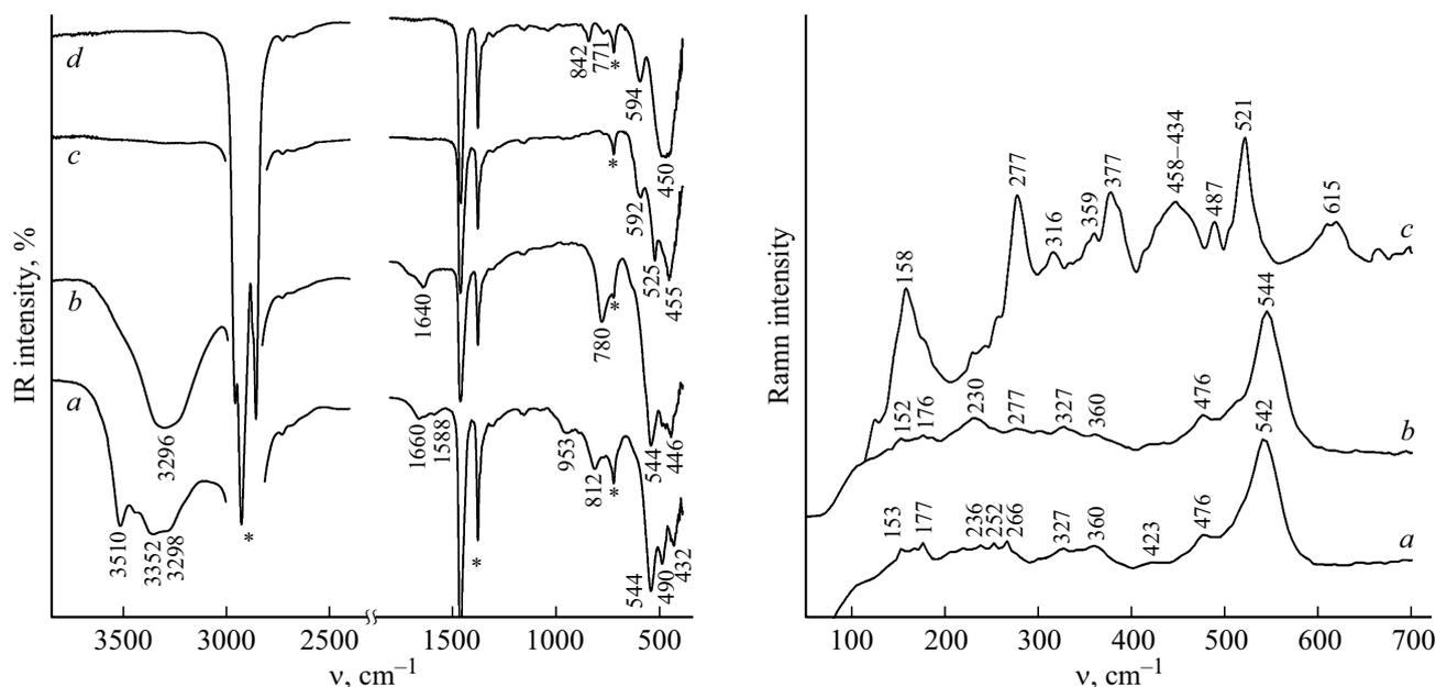
Рис. 4. Инфракрасные спектры и спектры КР  $\text{Na}_7\text{Zr}_6\text{F}_{31} \cdot 12\text{H}_2\text{O}$  (a),  $\text{Na}_7\text{Zr}_6\text{F}_{31} \cdot 6\text{H}_2\text{O}$  (b),  $\text{Na}_7\text{Zr}_6\text{F}_{31}$  (c), продукта нагревания до  $460^\circ\text{C}$  (d).
