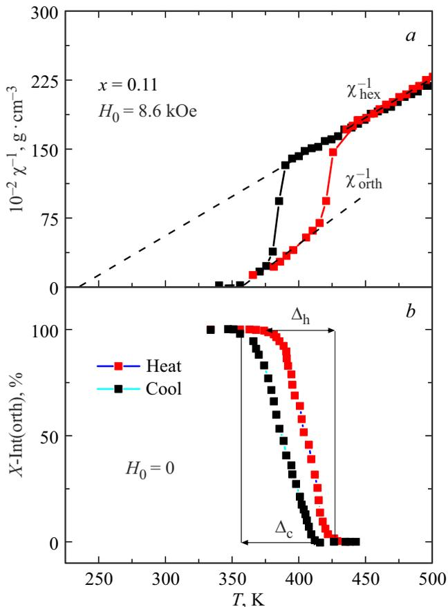
**Рис. 1.** Экспериментальные температурные зависимости обратной ПМ восприимчивости  $\chi^{-1}(T)$  и рентгеновской интенсивности  $X\text{-Int}_{\text{orth}}(T)$ , измеренные в соответствующих полях [1].
