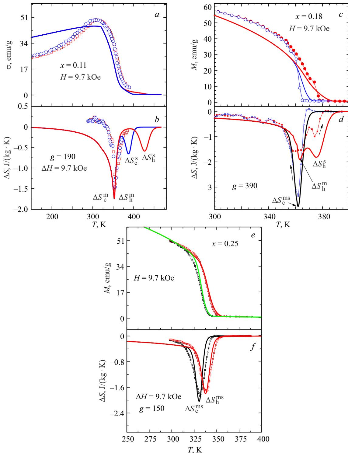
**Рис. 4.** Сопоставление температурных зависимостей магнитных  $M(T)$  и магнитокалорических  $\Delta S(T)$  характеристик для ряда образцов системы  $\text{Mn}_{1-x}\text{Cr}_x\text{NiGe}$ . Символы — экспериментальные данные из [19,16,19] соответственно; линии — модель.
