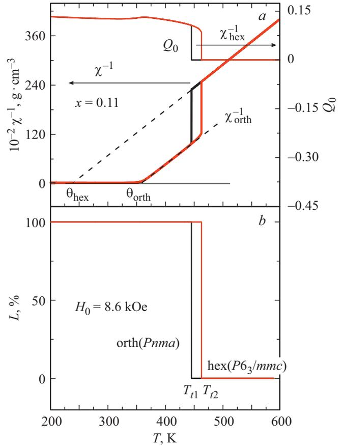
**Рис. 2.** Теоретические температурные зависимости обратной ПМ восприимчивости  $\chi^{-1}(T)$  функции фазового состояния  $L(T)$  в модели точечных структурных переходов 1-го рода.  $Q_0(T)$  — температурная зависимость параметра структурного порядка, описывающего точечный структурный переход  $\text{hex}(P6_3/mmc) \leftrightarrow \text{orth}(Pnma)$  в однородной среде [7–8].
