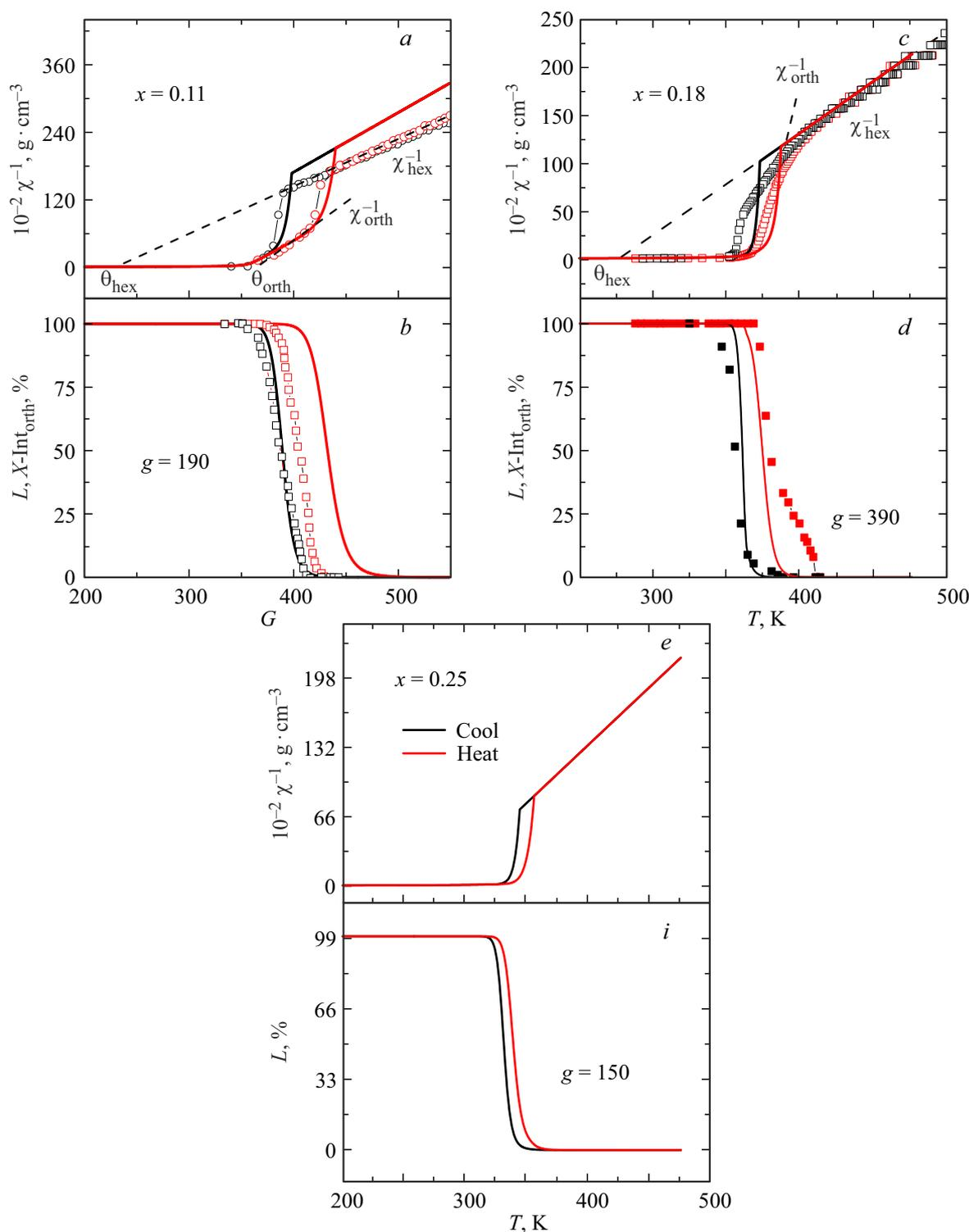
**Рис. 3.** Совмещенные экспериментальные (символы) и теоретические (линии) температурные зависимости магнитоструктурных характеристик ряда сплавов системы  $\text{Mn}_{1-x}\text{Cr}_x\text{NiGe}$  при атмосферном давлении.  $g$ -число структурных единиц в ромбическом зародыше; экспериментальные зависимости взяты из [1].
