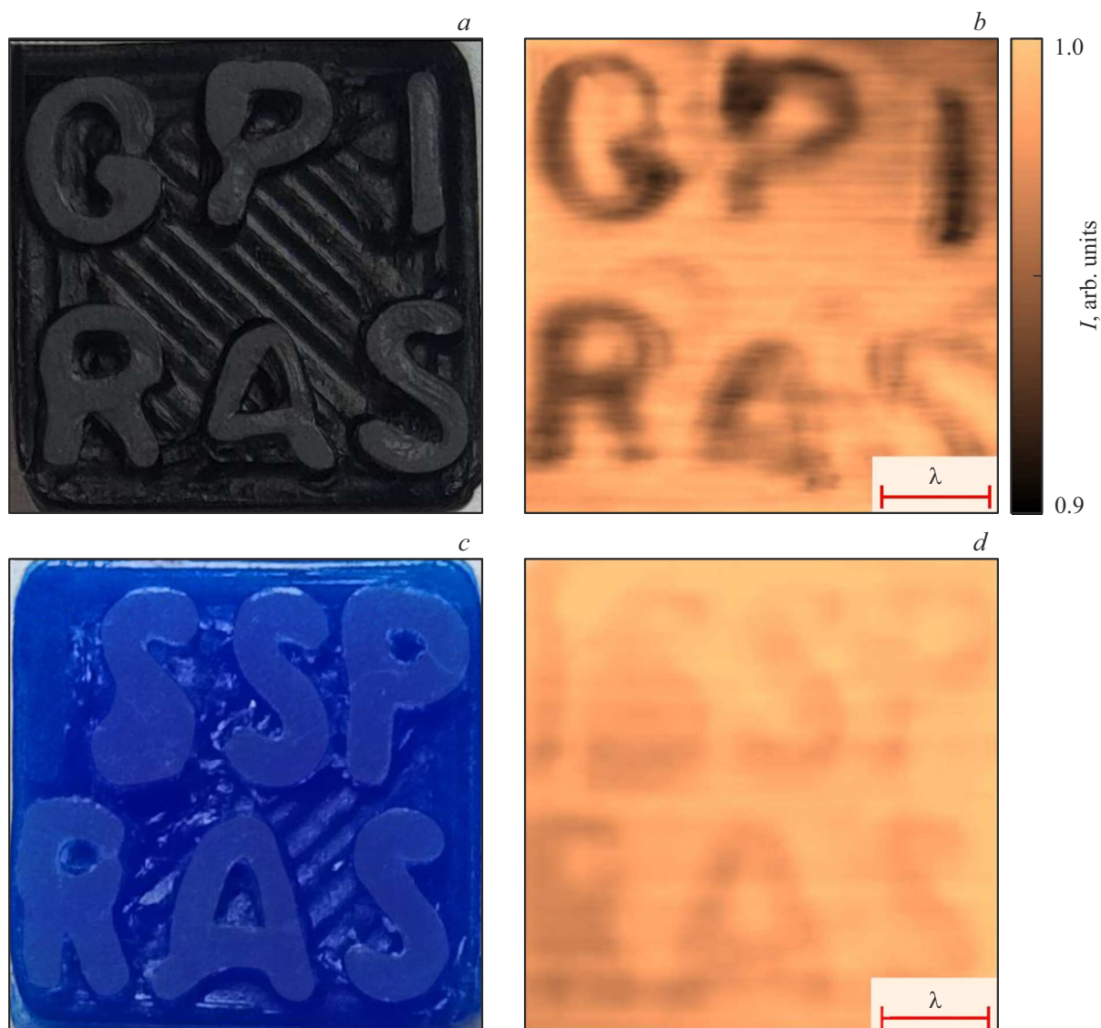
Рис. 5. ТГц микроскопия на основе эффекта твердотельной иммерсии объектов с субволновыми масштабами неоднородностей. (a)–(d) Фотографии и ТГц изображения полимерных логотипов ИОФ РАН, напечатанного на 3D-принтере (изготовлен из проводящего полимера ABS), а также ИФТТ РАН (полимер PLA).
