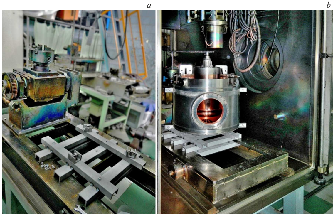
Рис. 5. a — оснастка для окончательной ЭСЛ задней стенки резонатора ВЧ пушки с обечайкой, b — ВЧ пушка в вакуумной камере ЭСЛ с этой оснасткой с цепью для привода вращения и электронной пушкой сверху.
