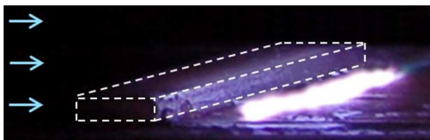
Рис. 4. Интегральный снимок оптического свечения плазмы разряда в потоке за УВ. Стрелками указано направление потока, штрих — границы препятствия.
