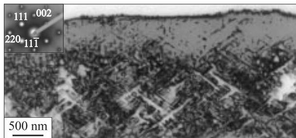
**Рис. 2.** Изображение в просвечивающем электронном микроскопе сечения пористого слоя GaAs (110) с порами вдоль направления [111]. На вставке — картина электронной микродифракции, указаны индексы дифракционных рефлексов.
