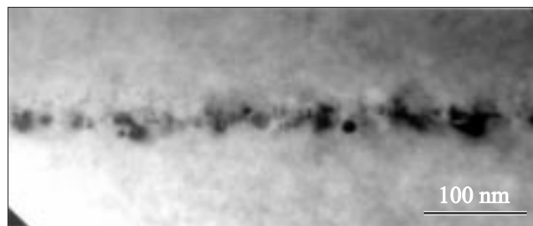
Рис. 1. Светлопольное ПЭМ-изображение ( g = 220 ) поперечного сечения структуры в области слоя LT-GaAs.
