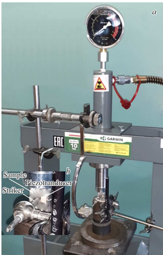
Рис. 1. Общий вид установки для анализа характеристик генерации АЭ при ударном повреждении одноосно сжатого образца; на вставке — узел сжимающей и ударной нагрузок.
