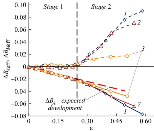
Рис. 7. Зависимости изменения  $B_{Aeff}$  (сплошная линия) и  $B_{Meff}$  (штриховая линия) от деформации  $\varepsilon$  при  $T = 20$  (1),  $40$  (2) и  $60^\circ\text{C}$  (3).
