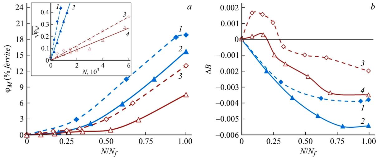
**Рис. 5.** Изменение  $\varphi_M$  (a) и  $B$  (b) при циклическом нагружении при  $\Delta\varepsilon/2 = 0.5\%$  и  $T = 20^\circ\text{C}$  (1),  $\Delta\varepsilon/2 = 0.5\%$  и  $T = 60^\circ\text{C}$  (2),  $\Delta\varepsilon/2 = 0.3\%$  и  $T = 20^\circ\text{C}$  (3),  $\Delta\varepsilon/2 = 0.3\%$  и  $T = 60^\circ\text{C}$  (4).
