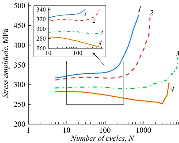
**Рис. 3.** Амплитуда напряжения в процессе циклического нагружения при  $\Delta\varepsilon/2 = 0.5\%$  и  $T = 20^\circ\text{C}$  (1),  $\Delta\varepsilon/2 = 0.5\%$  и  $T = 60^\circ\text{C}$  (2),  $\Delta\varepsilon/2 = 0.3\%$  и  $T = 20^\circ\text{C}$  (3),  $\Delta\varepsilon/2 = 0.3\%$  и  $T = 60^\circ\text{C}$  (4).
