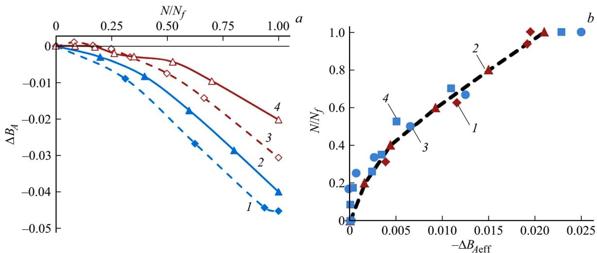
**Рис. 9.** Изменение  $B_A$  (a) и  $\Delta B_{Aeff}$  (b) при циклическом нагружении при  $\Delta\varepsilon/2 = 0.5\%$  и  $T = 20^\circ\text{C}$  (1),  $\Delta\varepsilon/2 = 0.5\%$  и  $T = 60^\circ\text{C}$  (2),  $\Delta\varepsilon/2 = 0.3\%$  и  $T = 20^\circ\text{C}$  (3),  $\Delta\varepsilon/2 = 0.3\%$  и  $T = 60^\circ\text{C}$  (4).
