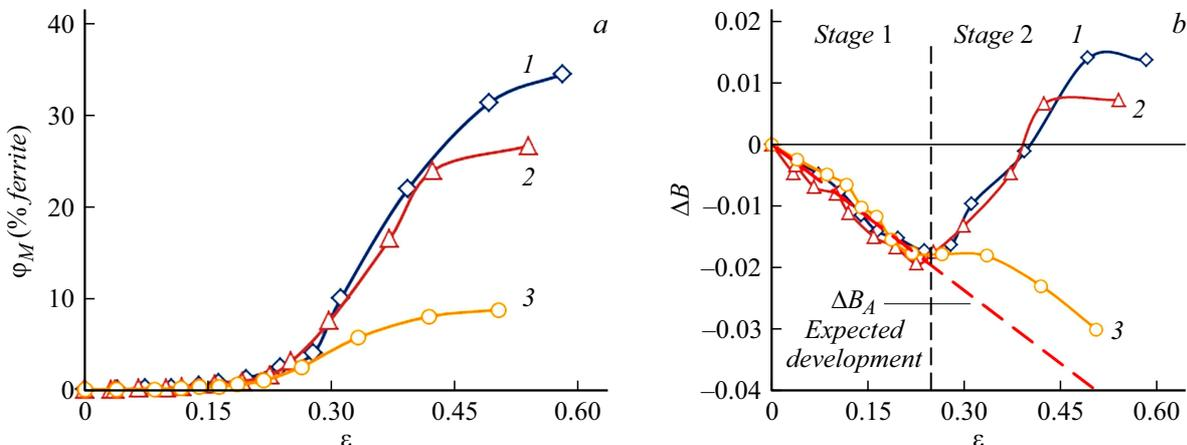
**Рис. 4.** Зависимость объемной доли  $\alpha'$ -мартенсита  $\varphi_M$  (a) и  $\Delta B$  (b) от пластической деформации  $\varepsilon$  для стали 12X18H10T при температурах испытания: 20 (1), 40 (2) и  $60^\circ\text{C}$  (3) [24].
