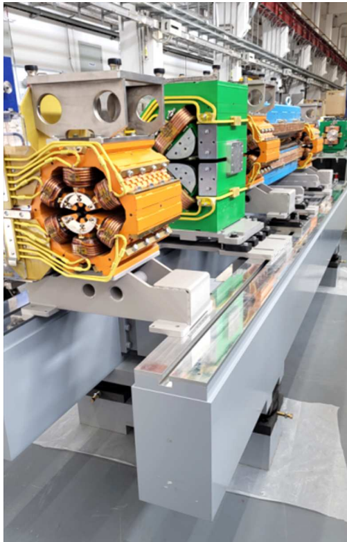
Рис. 6. Магнитные сборки на балках для накопителя (слева) и для бустерного синхротрона СКИФ [9].
