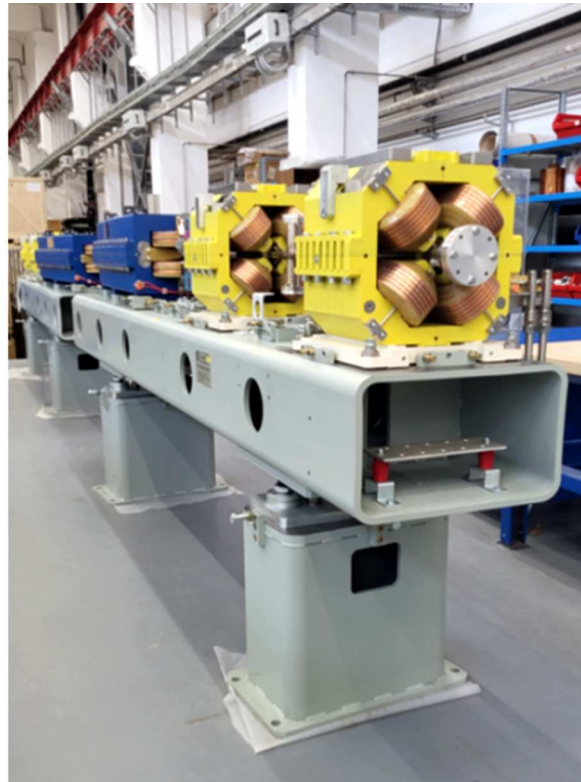
Рис. 6. Магнитные сборки на балках для накопителя (слева) и для бустерного синхротрона СКИФ [9].
