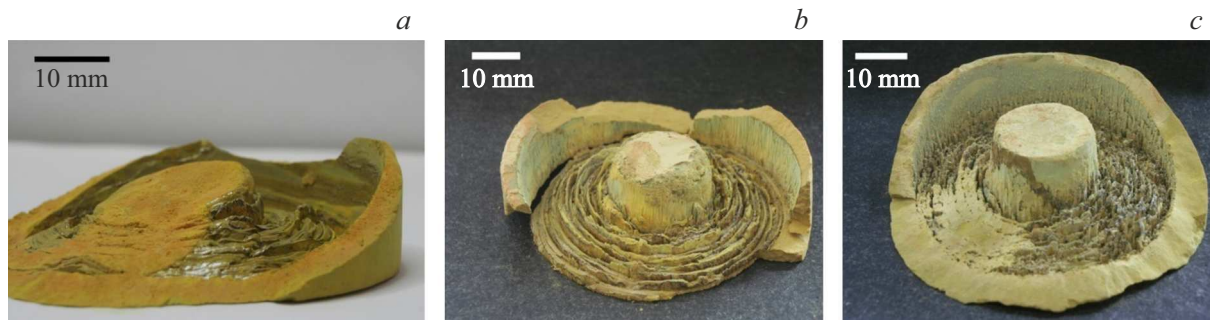
Рис. 2. Фотография остатков мишеней после получения нанопорошков ZnSe в Ar атмосферного давления ( p = 100 kPa, (a, b)) и избыточного давления ( p = 300 kPa, (c)). Режим генерации лазерного излучения — импульсно-периодический (a) и непрерывный (b, c).
