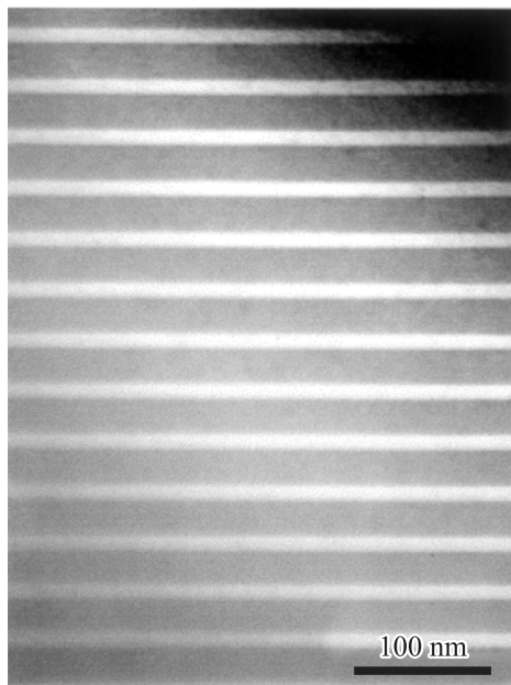
Рис. 2. ПЭМ изображение поперечного сечения структуры F237, полученное в режиме темного поля в рефлексе ( g = 200 ).
