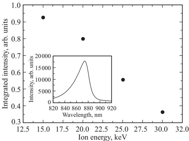
**Рис. 3.** Относительная интегральная интенсивность фотолюминесценции в зависимости от величины энергии ионов. На вставке приведен спектр фотолюминесценции  $\text{Al}_{0.18}\text{Ga}_{0.82}\text{As}/\text{GaAs}/\text{Al}_{0.18}\text{Ga}_{0.82}\text{As}$ -гетероструктуры из области, вытравленной ионами с энергией 30 кэВ.
