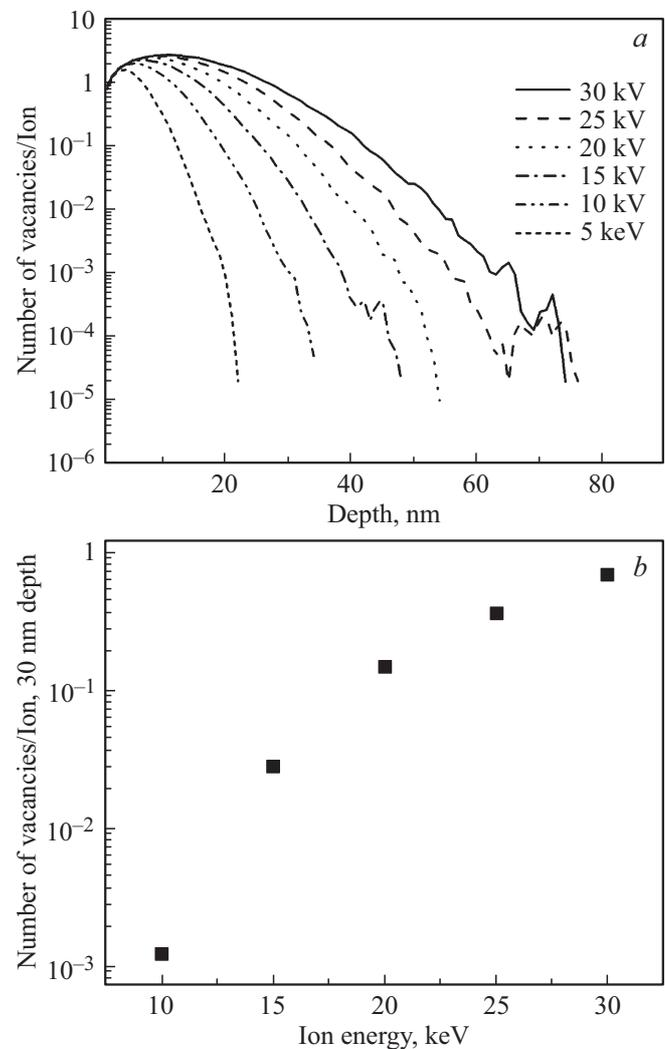
**Рис. 5.** Результаты численного расчета в программе SRIM: *a* — пространственного распределения приведенного общего количества вакансий Al, Ga, As в слое  $\text{Al}_{0.18}\text{Ga}_{0.82}\text{As}$  и *b* — приведенного общего количества вакансий на ион на расстоянии 30 нм от фронта травления в зависимости от энергии ионов.
