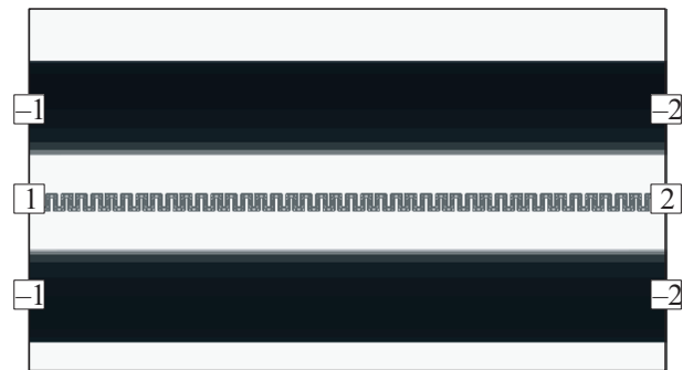
Рис. 3. Распределение тока в джозефсоновских контактах, встроенных в копланарную линию передач.
