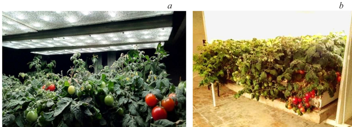
Рис. 4. Общий вид экспериментальных вегетационных светоустановок с растениями томата: a — под светодиодными светильниками, b — под лампами ДНаЗ.
