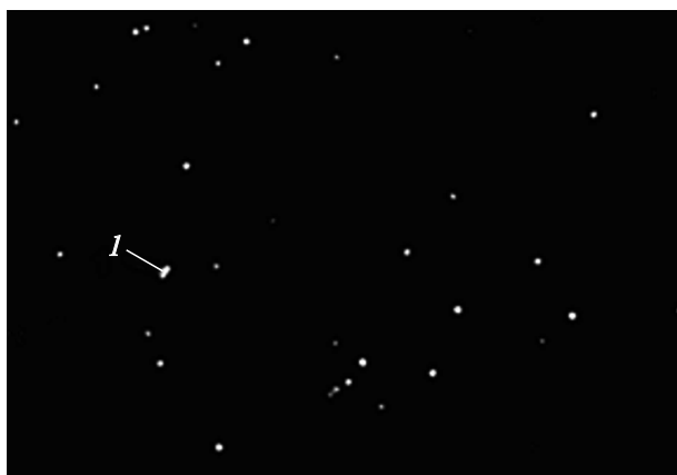
Рис. 3. Изображение фрагмента поля зрения, соответствующее лучшему значению параметра качества фокусировки после процедуры фокусировки.
