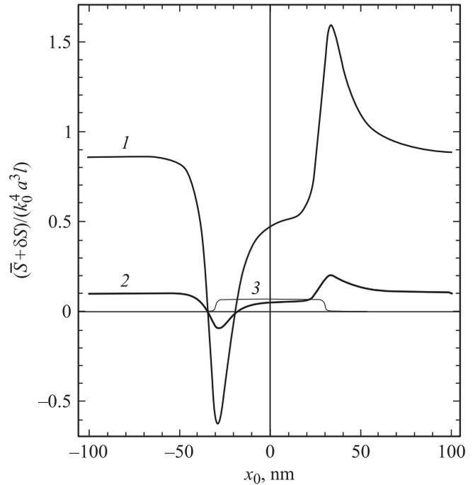
**Рис. 7.** Нормированное сечение магнитооптического рассеяния  $\bar{S} + \delta S$  в зависимости от  $x_0$  в плазменном резонансе  $\hbar\omega = 3.75$  eV (1) и вне его при  $\hbar\omega = 3.3$  eV (2) для распределения намагниченности (3). Вычислено при  $\theta = 45^\circ$ ,  $\theta' = 60^\circ$ ,  $\Delta = 0.5$  nm,  $w = 30$  nm; остальные параметры те же, что на рис. 3 и 4.
