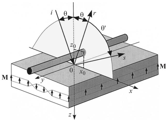
Рис. 1. Геометрия магнитооптического рассеяния света через ближнее поле линейного зонда: падающая (*i*), зеркально отраженная (*r*) и рассеянная (*s*) волны.
