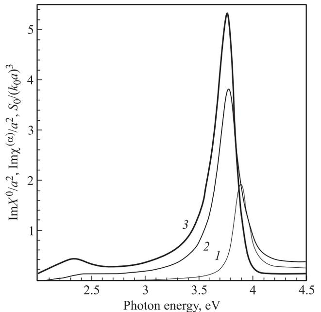
**Рис. 3.** Нормированные спектры поглощения света цилиндром Ag в вакууме  $\text{Im} X^0/a^2$  (1) и вблизи поверхности Au  $\text{Im} \chi^{(\alpha)}/a^2$  (2), а также спектр  $S_0$  упругого рассеяния  $p \rightarrow p$  приповерхностным цилиндром при  $\theta = 0^\circ$  и  $\theta' = 45^\circ$  (3). Вычислено с диэлектрическими функциями Ag и Au из [21] при  $\Omega = \pi/4$ ,  $\varepsilon_1 = 1$ ,  $a = 4.5 \text{ nm}$ ,  $z_0 = -5 \text{ nm}$ .
