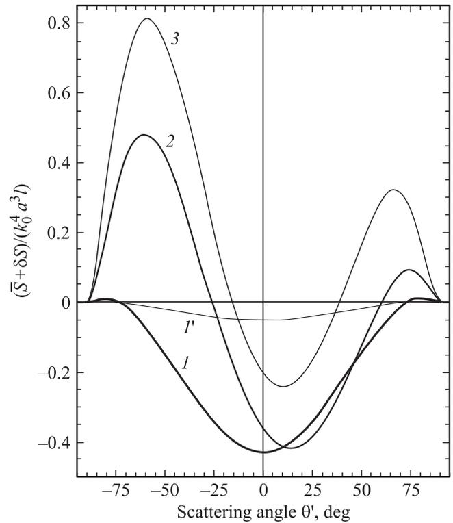
**Рис. 5.** Нормированные сечения магнитооптического рассеяния  $\bar{S} + \delta S$  в зависимости от угла  $\theta'$  при  $\theta = 0^\circ$  (1),  $\theta = 30^\circ$  (2) и  $\theta = 60^\circ$  (3) в плазменном резонансе ( $\hbar\omega = 3.75$  eV) и  $\theta = 0^\circ$  (1') — вне резонанса ( $\hbar\omega = 3.3$  eV). Вычислено при  $x_0 = 0$  с теми же параметрами, что на рис. 3 и 4.
