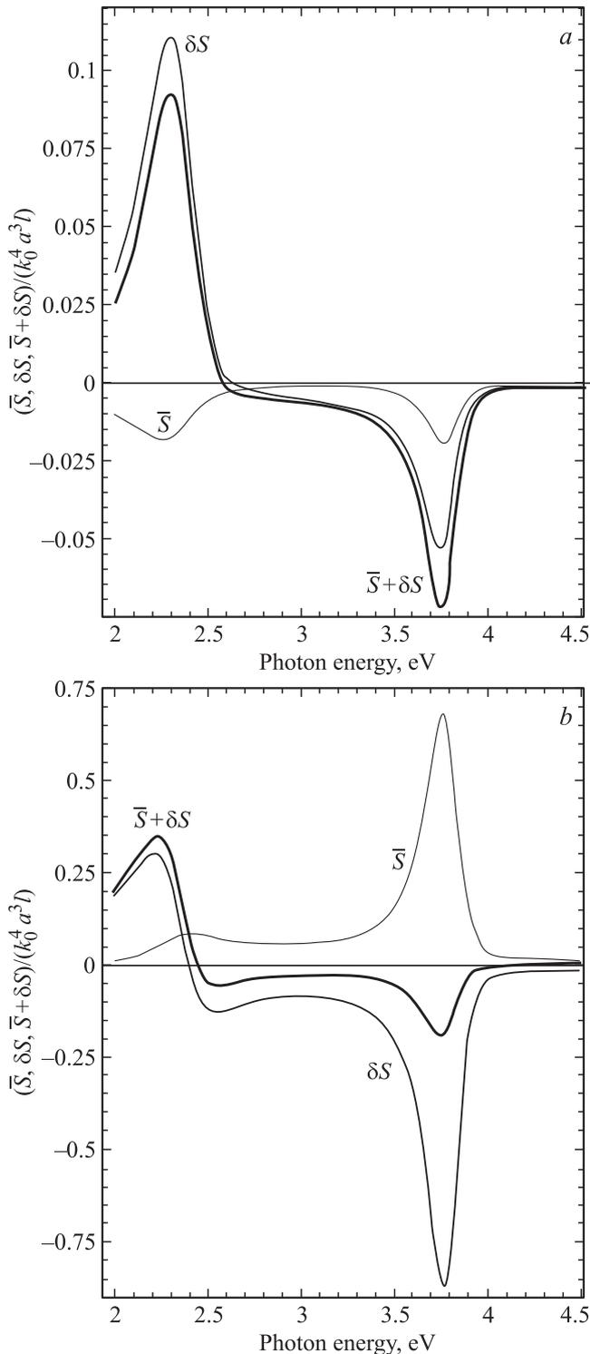
**Рис. 4.** Нормированные магнитооптические спектры  $\bar{S}$ ,  $\delta S$  и  $\bar{S} + \delta S$  рассеяния, где  $\bar{S}$  и  $\delta S$  — вклады латерально однородной и неоднородной намагниченности соответственно. Вычислено с  $x_0 = 0$  при  $\theta = 0^\circ$ ,  $\theta' = 60^\circ$  (a) и  $\theta = 30^\circ$ ,  $\theta' = 45^\circ$  (b); остальные параметры те же, что на рис. 3.
