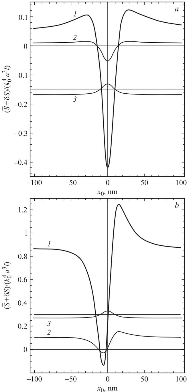
**Рис. 6.** Нормированное сечение магнитооптического рассеяния  $\bar{S} + \delta S$  как функция координаты сканирования  $x_0$  в плазменном резонансе  $\hbar\omega = 3.75$  eV (1) и вне его при  $\hbar\omega = 3.3$  eV (2) для распределения намагниченности (3). Вычислено при  $\theta = 0^\circ$ ,  $\theta' = 10^\circ$  (a) и  $\theta = 45^\circ$ ,  $\theta' = 60^\circ$  (b) с  $\Delta = 10$  nm,  $w = 2$  nm; остальные параметры те же, что на рис. 3 и 4.
