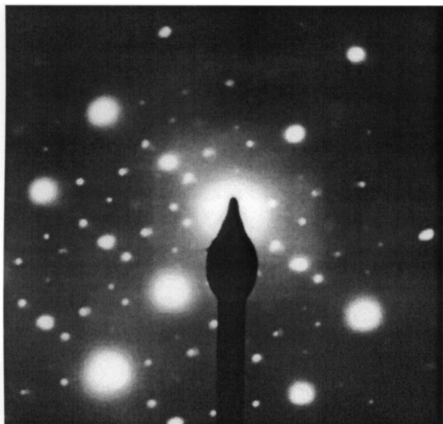
Рис. 2. Экспериментальная ( a ) микродифракционная картина монооксида титана \text{TiO}_{1.087} и компьютерное моделирование микродифракции ( b ) для монооксида \text{TiO}_{0.187} с параметром базисной кристаллической решетки a_{B1} = 0.4174 nm (направление электронного пучка [011]_{C2/m} \equiv [112]_{B1} ). На рисунке указаны индексы структурных отражений.
