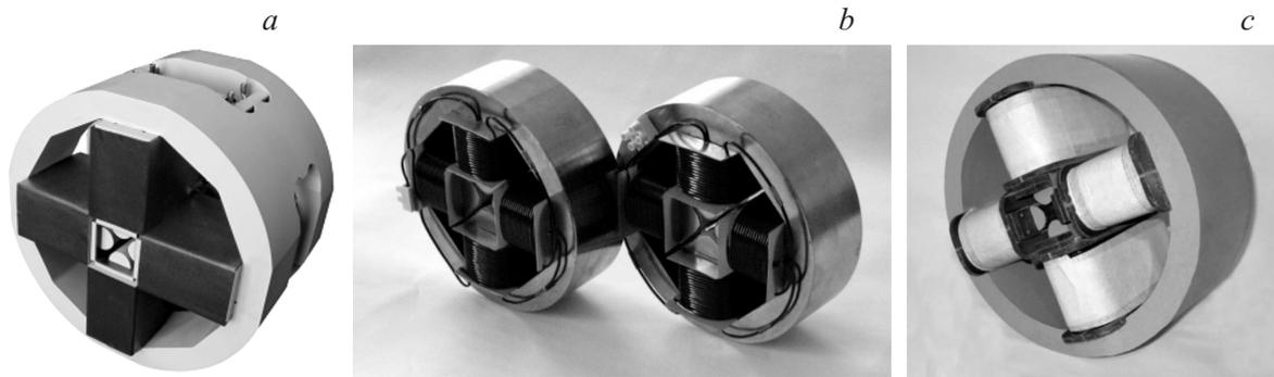
Рис. 4. Типы магнитных квадрупольных линз: *a* — интегрированный дублет МКЛ, *b* — OM50m, *c* — IAP.
