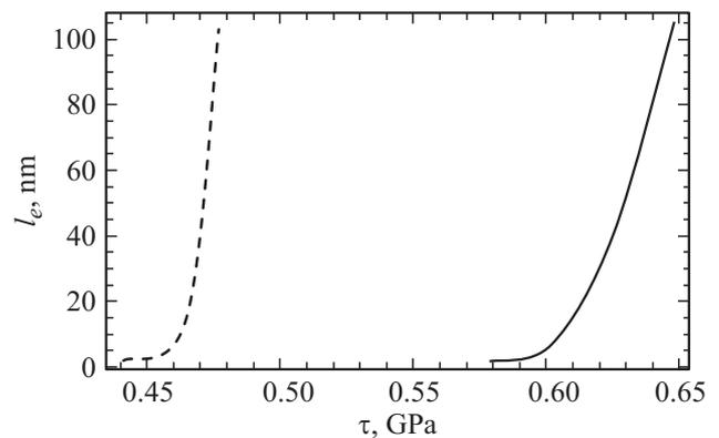
**Рис. 3.** Зависимости равновесной длины  $l_e$  нанотрещины, зарождающейся на дислокационном скоплении в меди, от величины приложенного сдвигового напряжения  $\tau$  для случая  $d = 600$  nm и  $\alpha = 70^\circ$ . Сплошная и штрихованная кривые показывают зависимости соответственно для трещины вблизи поверхности и трещины в бесконечном теле.
