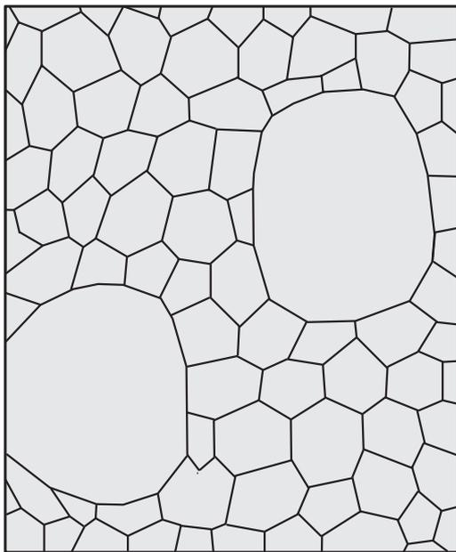
Рис. 1. Наноматериал с бимодальной структурой (схематически).
