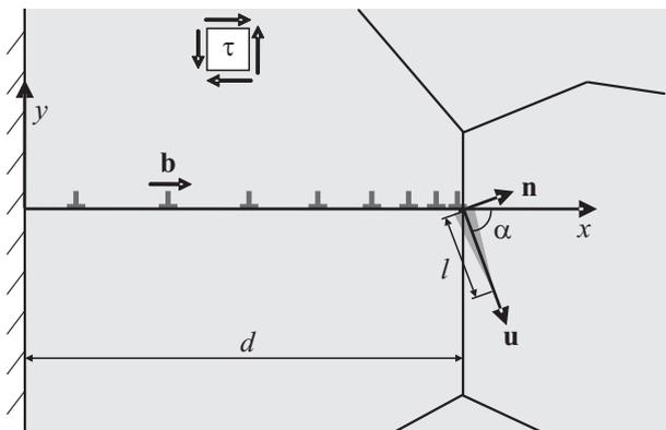
Рис. 2. Зарождение нанотрещины на дислокационном скоплении, заторможенном на границе зерна вблизи свободной поверхности деформируемого металла с бимодальной структурой.
