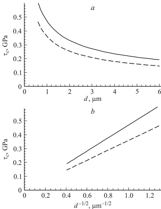
**Рис. 4.** Зависимости критического сдвигового напряжения  $\tau_c$  для зарождения нанотрещины в поле напряжений дислокационного скопления от размера  $d$  большого зерна (*a*) и параметра  $d^{-1/2}$  (*b*). Сплошные и штрихованные кривые показывают зависимости соответственно для трещины вблизи поверхности и трещины в бесконечном твердом теле.
