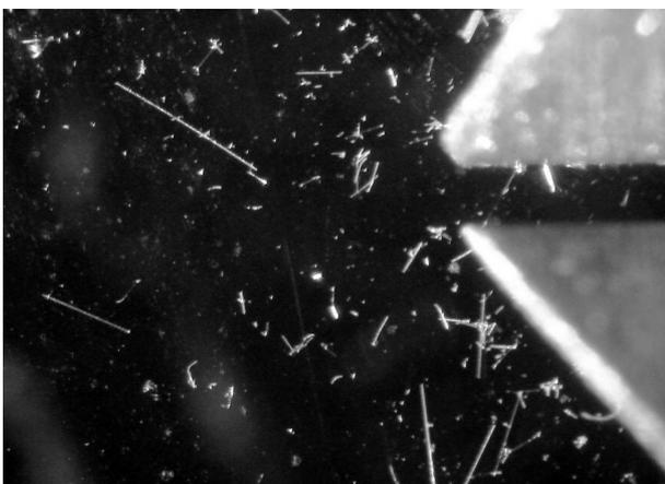
**Рис. 4.** Изображение отдельных ННК, синтезированных при температуре подложки  $T_s = 923$  К. Время синтеза 30 мин. Справа на микрофотографии — измерительное средство, раскрытое на величину 300 мкм.
