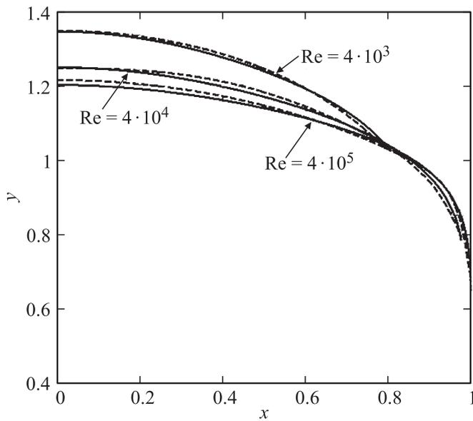
Расчетные (пунктирные) и эталонные (сплошные) профили скоростей турбулентного ядра потока в трубе при различных числах  $Re$  ( $x$  — относительный радиус,  $y$  — относительная скорость).
