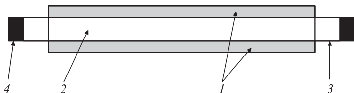
Рис. 1. Первый вариант счетчика тепловых нейтронов: 1 — сцинтиллятор ZnS(Ag)/LiF, 2 — световод (органическое стекло), 3 — фокусирующая призма световода, 4 — лавинный фотодиод.
