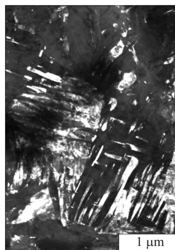
Рис. 3. Трансмиссионная электронная микроскопия поверхности сплава ВТ1-0 после воздействия 3 импульсами.
