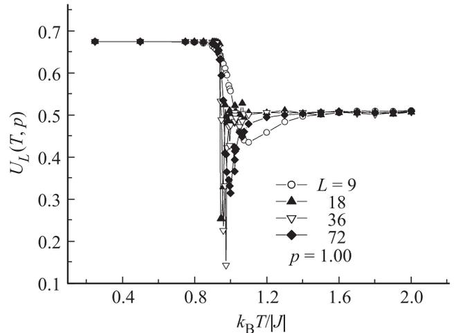
**Рис. 2.** Температурная зависимость кумулянтов Биндера  $U_L(T, p)$  для неразбавленной АФ-модели Поттса при отсутствии структурного беспорядка ( $p = 1.00$ ).
