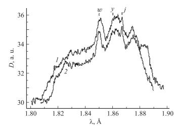
Денситограммы спектров, полученных спектрографами с ориентацией плоскости дисперсии параллельно (I) и перпендикулярно (2) оси разряда. Символы w и y обозначают положение резонансной и интеркомбинационной линий гелиеподобных ионов железа, а символ j — соответствующего сателлита резонансной линии.
