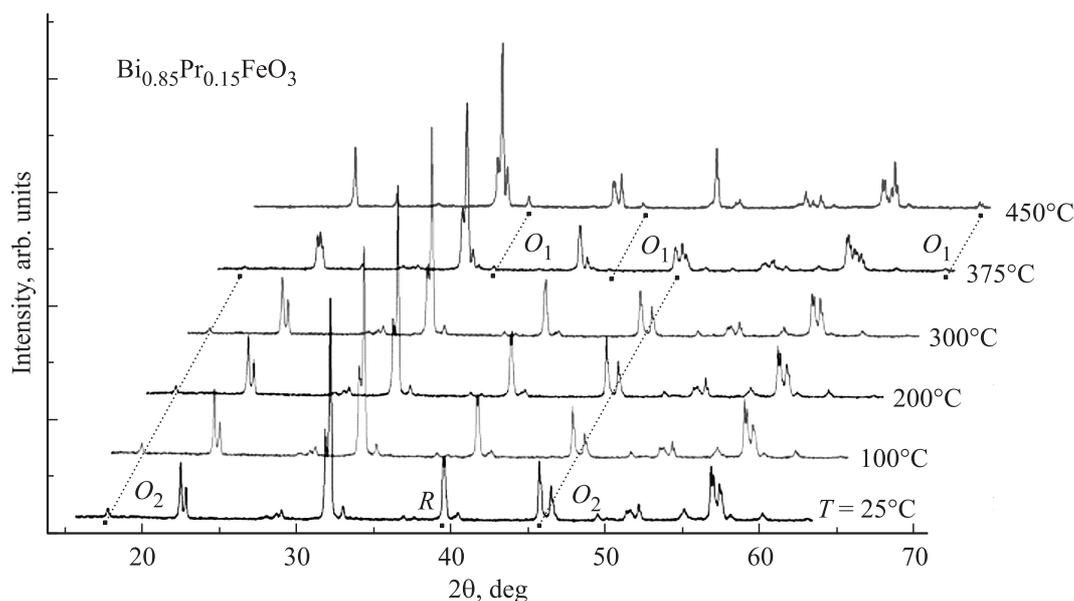
**Рис. 4.** Рентгенограммы состава  $\text{Bi}_{0.85}\text{Pr}_{0.15}\text{FeO}_3$ , полученные при различных температурах.
