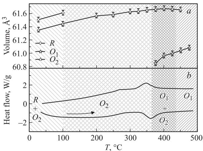
**Рис. 5.** *a)* Изменение объема элементарной ячейки структурных фаз состава  $Bi_{0.85}Pr_{0.15}FeO_3$  (на формульную единицу). *b)* Температурные зависимости DSC, области существования структурных фаз заштрихованы и обозначены соответствующими буквами.
