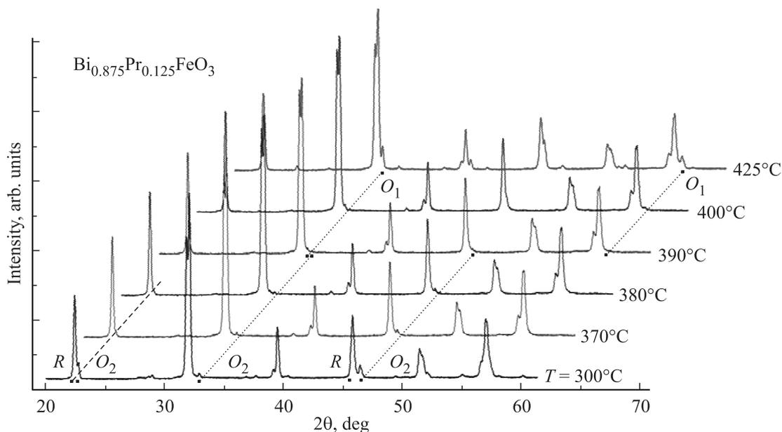
Рис. 1. Рентгенограммы состава  $\text{Bi}_{0.875}\text{Pr}_{0.125}\text{FeO}_3$ , полученные при различных температурах.
