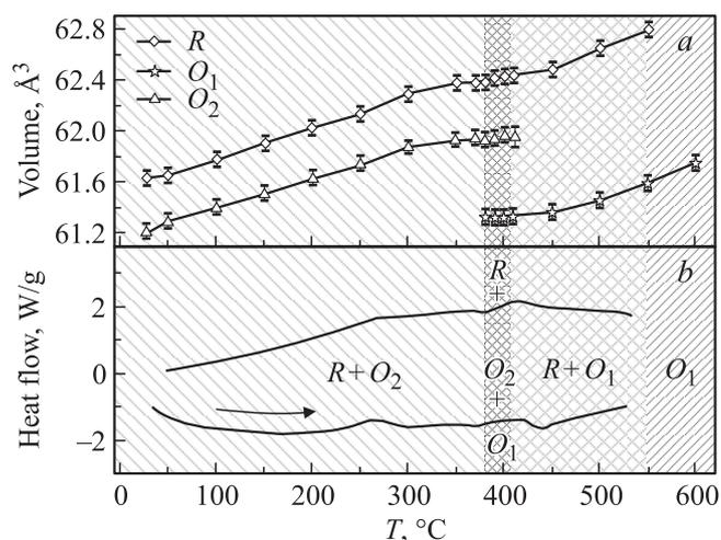
**Рис. 3.** *a*) Температурное изменение объема элементарной ячейки структурных фаз состава  $\text{Bi}_{0.875}\text{Pr}_{0.125}\text{FeO}_3$  (на формульную единицу). *b*) Температурные зависимости DSC, области существования структурных фаз заштрихованы и обозначены соответствующими буквами.
