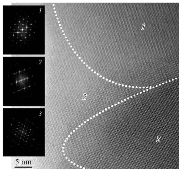
Рис. 2. HRTEM-изображение при  $T = 390^\circ\text{C}$  (пунктирной линией выделены области разных структурных фаз). На вставках представлены результаты FFT образов, полученных на соответствующих областях HRTEM-изображения.
