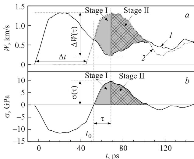
**Рис. 1.** Реконструкция зависимости растягивающих напряжений  $\sigma$  от времени  $t$  при отколе — профили  $\sigma(t)$  в сечении откола согласно [9] и подразделение процесса откольного разрушения на две стадии согласно [8] (пояснения приведены в тексте).
