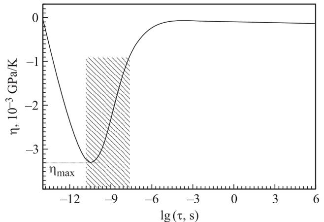
**Рис. 3.** График частной производной (7) температурной зависимости прочности (5) алюминия.
