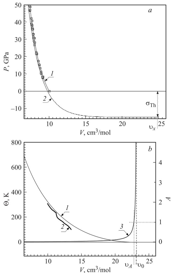
**Рис. 5.** Теплофизические свойства алюминия в области сжатия и растяжения. *a*) 1 — расчетная ударная адиабата алюминия, квадраты — экспериментальная ударная адиабата алюминия из [14], 2 — потенциальное давление (16). *b*) 1 — характеристическая температура (10), 2 — объемная зависимость  $\theta(V) = 0.75\theta_D$ , где  $\theta_D = \theta_D(V)$  — расчет объемной зависимости температуры Дебая из [15], 3 — объемная зависимость параметра де Бура (20) для алюминия.
