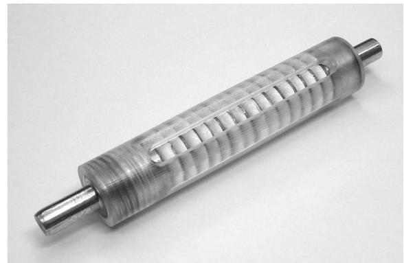
Рис. 2. Внешний вид коммутатора.
