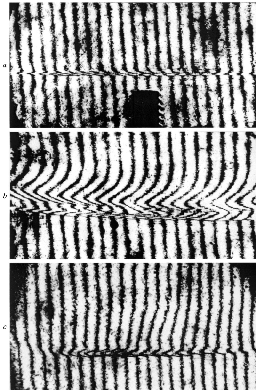
**Рис. 2.** Голографические интерферограммы акустической волны, генерируемой при взаимодействии излучения  $\text{CO}_2$  лазера со свободной поверхностью воды при плотностях энергии  $\varepsilon_L = 1$  (a) и  $3 \text{ J/cm}^2$  (b). Расстояние от поверхности  $d = 7 \text{ cm}$ ; c — взаимодействие с жесткой границей (германий–вода),  $\varepsilon_L = 0.5 \text{ J/cm}^2$ ,  $d = 0.6 \text{ cm}$ .
