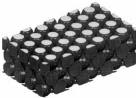
**Рис. 1.** Плотная упаковка шаров, образующая гранцентрированную кубическую решетку (модель структуры опала).
