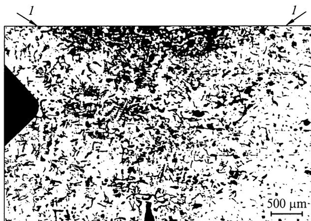
Рис. 2. Микроструктура зоны зеркальной матрицы. 1 — граница расплавленной области.
